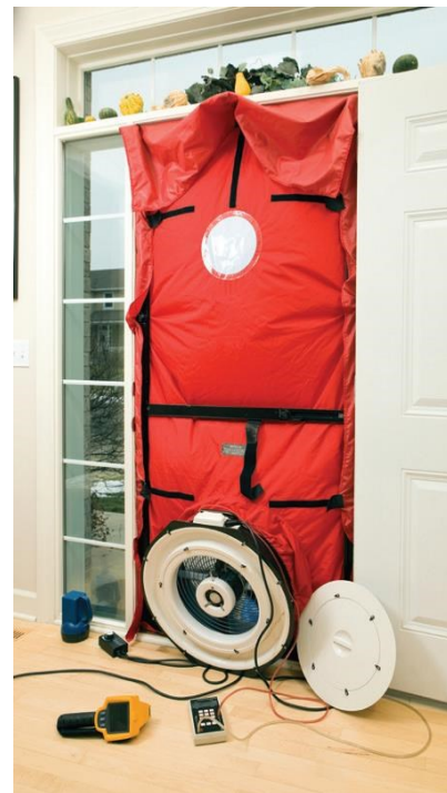
Blower Door Test
